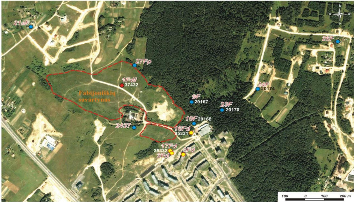
2 pav. Fabijoniškių švartyno dujų ir hidrocheminio monitoringo postų schema.
